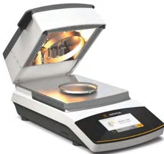
Fig. 18. Termobalanza Sartorius MA37 empleada para la determinación de la humedad del material absorbente de CO 2 previo a la prueba.
