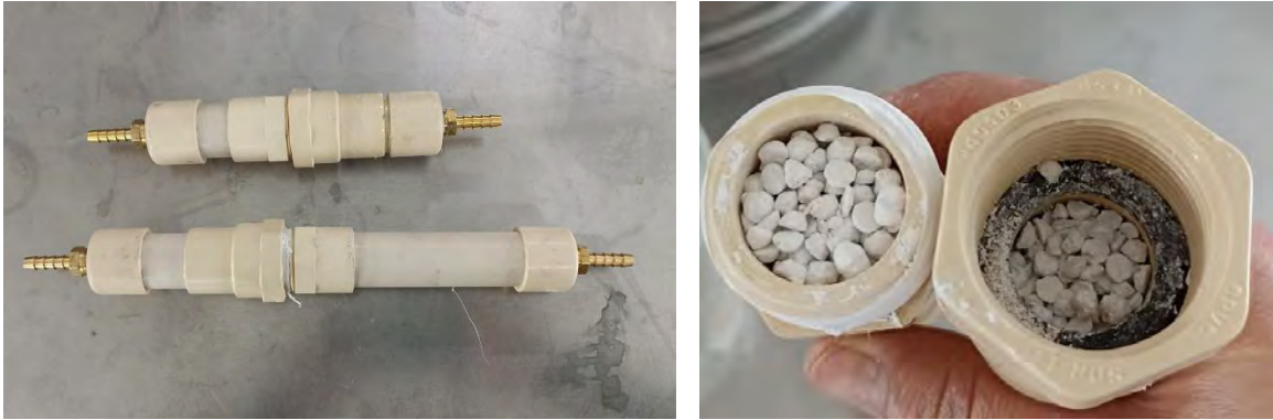
Fig. 25. Prototipo de columnas empacadas empleadas en el sistema de purificación de biogás.
