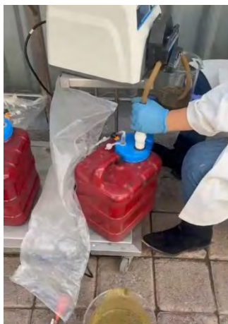
Fig. 23. Proceso de alimentación de reactores.
