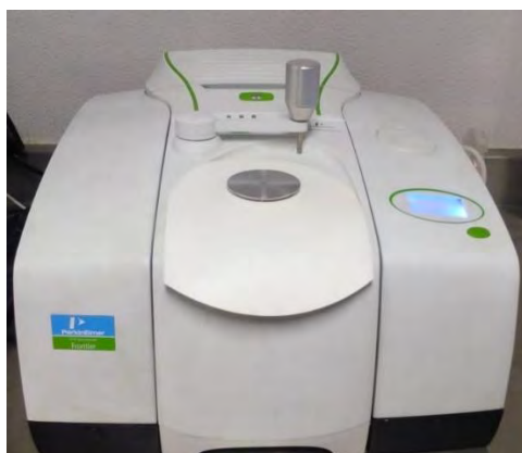
Figura 14. Espectrofotómetro de Transformada de Fourier (Perkin- Elmer) utilizado para la técnica FTIR
