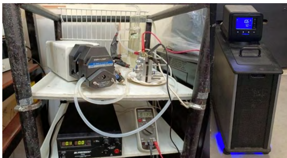
Figura 30. Banco de pruebas del electrolizador de prueba tipo PEM.
