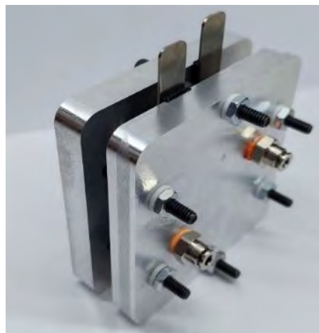
Figura 26. Electrolizador tipo PEM con un área geométrica de 5 \text{ cm}^2 diseñado por ESIME-ESIQIE.
