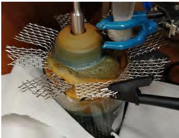
Figura 22. Espumas producidas por el proceso de EC - EF, sin la adición de quitosano.
