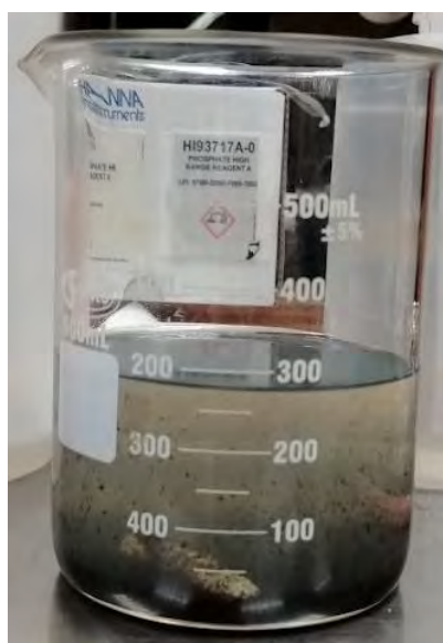
Figura 31. Sedimentación de la muestra, utilizando como coagulante cloruro férrico
