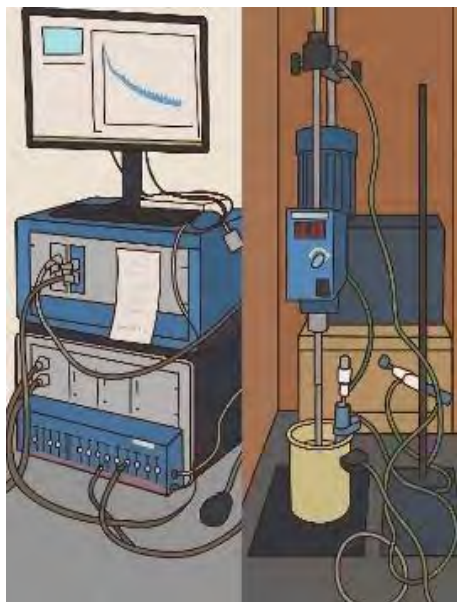
Figura 14. Esquema visual del sistema completo de EC-EF, el cual consiste en un potenciostato, celda electroquímica, electrodos de trabajo y de referencia, y cáframo.
