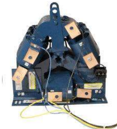
Figura 5.22. fotografía del fitro ( dv/dt ) utilizado.
