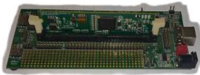
Figura 5.24 Tarjeta de control TMS320F28335 en la placa base “Docking Station”
