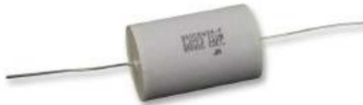
Figura A.1. Aspecto del capacitor de snubber .
