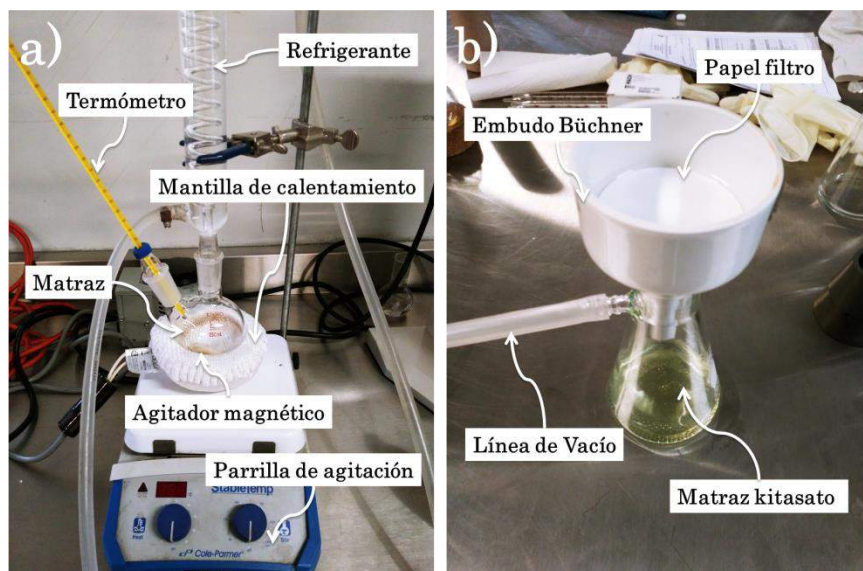
Figura 8. Material utilizado en el pretratamiento ácido y alcalino: a) sistema de reacción y b) sistema de filtración.
