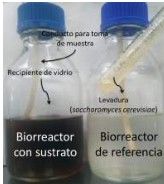
Figura 12. Material utilizado para monitorear el crecimiento de la levadura saccharomyces cerevisiae
