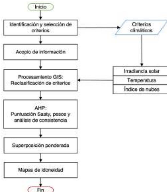
Figura 39 Diagrama metodológico para seleccionar el tipo de tecnología fotovoltaica en México
