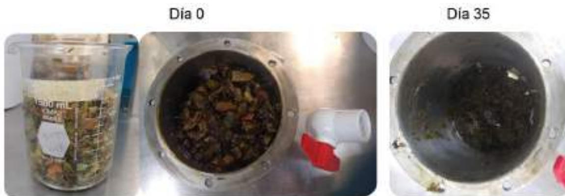
Figura 17. Reactores antes y después del proceso de digestión anaerobia termófila en reactor de mayor volumen.
