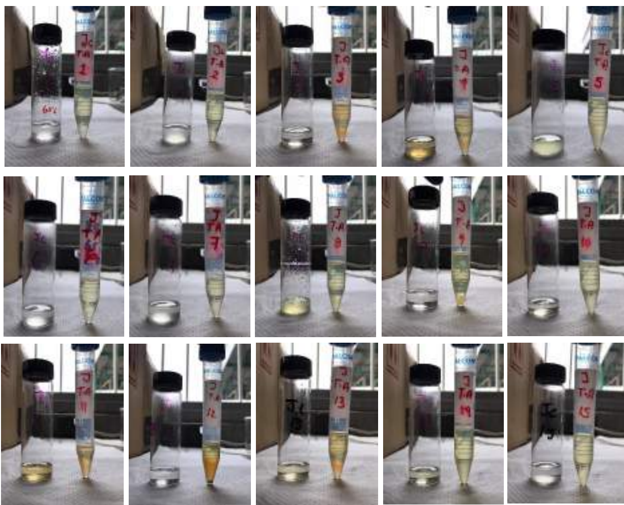
Figura 51 Experimentos del diseño de Box-Behnken utilizando aceite de Jatropha curcas L. y K_2FeO_4 como catalizador
