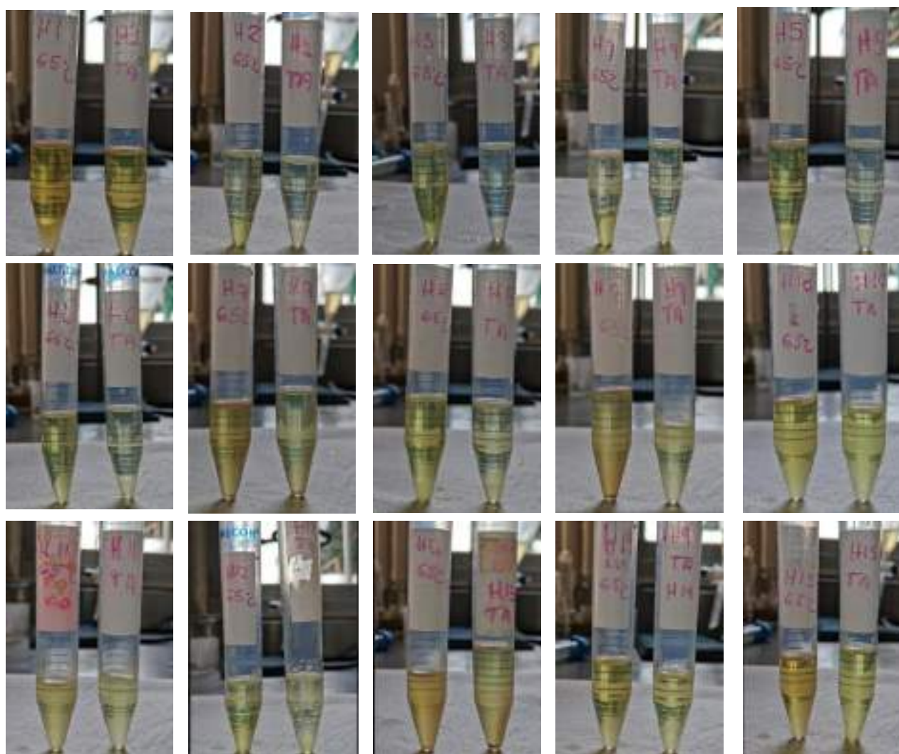
Figura 55 Experimentos del diseño de Box Behnken utilizando aceite de Ricinus communis y K_2FeO_4 como catalizador
