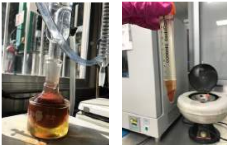
Figura 40 Reacciones de transesterificación usando \text{NaFeTiO}_4 como catalizador (derecha) y productos de reacción separados por centrifugación (derecha)
