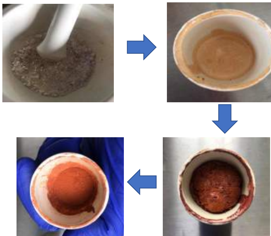
Figura 30 Síntesis de \text{NaFeTiO}_4 por estado sólido
