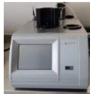
Figura 21 Equipo para determinación de punto de nube y punto de taponamiento en frío
