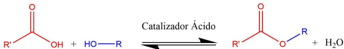
Figura 2 Reacción general de esterificación. Fuente: (Ruhul et al., 2015)
