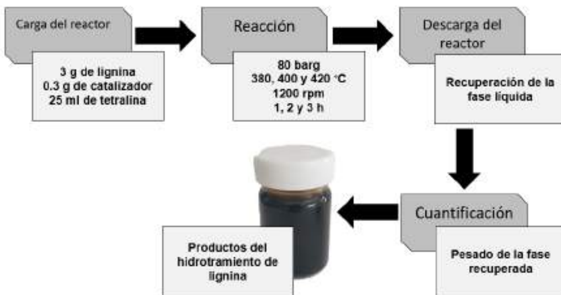
Figura 9. Sistema de reacción para el hidroprocesamiento de lignina de pino de Ocote mexicano.
